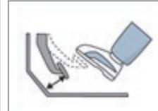
クラッチペダルの効きを点検します。効きが悪いと、ギアの切替が困難になる恐れがあります。
